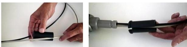
Kabel und Vakuumschlauch durch die Ausfräsung der Kunststoffhülse schieben.
