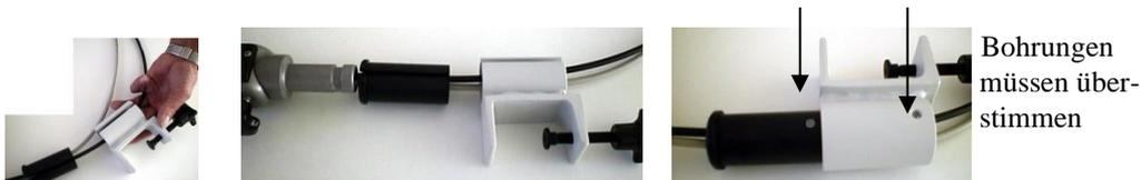
Kabel und Vakuumschlauch durch die Ausfräsung der Tischhalterung schieben.
